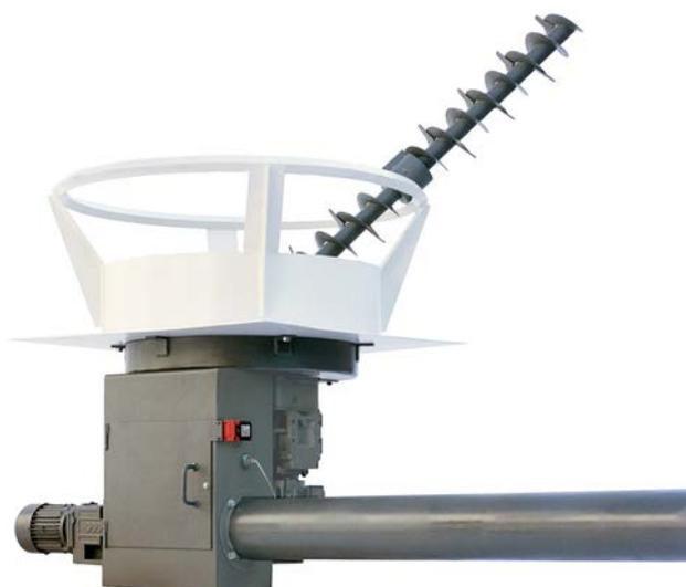
Поворотные шнеки выгрузки силоса от 3 до 6 м диаметра силоса для всех видов опилок и измельчения до размера G 30 согласно ÖNORM M 7133. Специально также для силосных установок, которые длительное время в году не эксплуатируются (Отопительный сезон).
