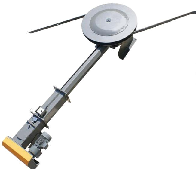
Выгрузка силоса с разрыхлением 2,5 до 6 м диаметра силоса для всех видов сухих опилок и измельчения до G 30 согласно ÖNORM M 7133. Пакет пружин разрыхляет складированное топливо и снабжает шнек выгрузки топливом.
