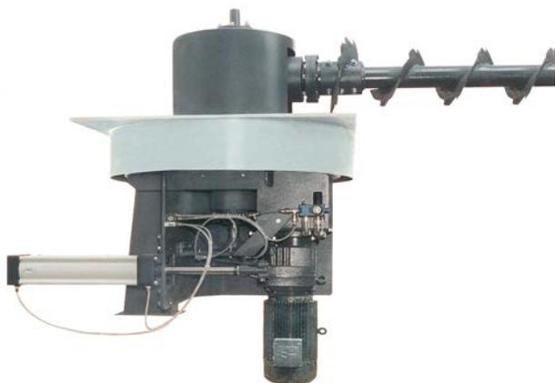
Горизонтальная выгрузка силоса до 8 м диаметра силоса для всех видов сухих опилок и измельченного материала до размера G 30 согласно ÖNORM M 7133. Работа шнека осуществляется от привода сжатого воздуха , поэтому не требуется дополнительный гидравлический агрегат. Специально для силосных установок , которые очищаются с ровного днища .
