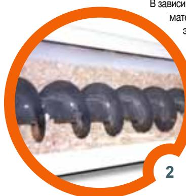
В зависимости от потребности сжигаемого материала регулирует «СПС» на электрораспределительном щите транспортную мощность наполнительного шнека. Для быстрого забора опилок, стружки и щепки в контейнер или в грузовик можно использовать высоко мощный транспортный шнек.
