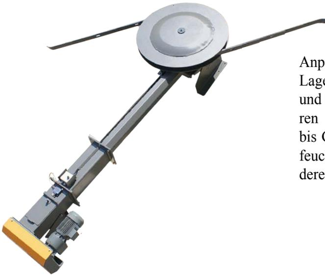
Anpassbare Federaustragungen, für Bunker und andere Lagerräume/keller bis zu einer max. Füllhöhe von 4 – 6 m und Silodurchmesser von 2,5 – 6 m geeignet. Sie transportieren Frässpäne, Hobelspäne, Sägespäne und Hackschnitzel bis Größe G30 (nach ÖNORM M 7133) in trockenem oder feuchtem (nicht gefrorenem) Zustand aus Vorratsräumen, deren Bodenniveau gleich oder höher als im Kesselraum ist.
