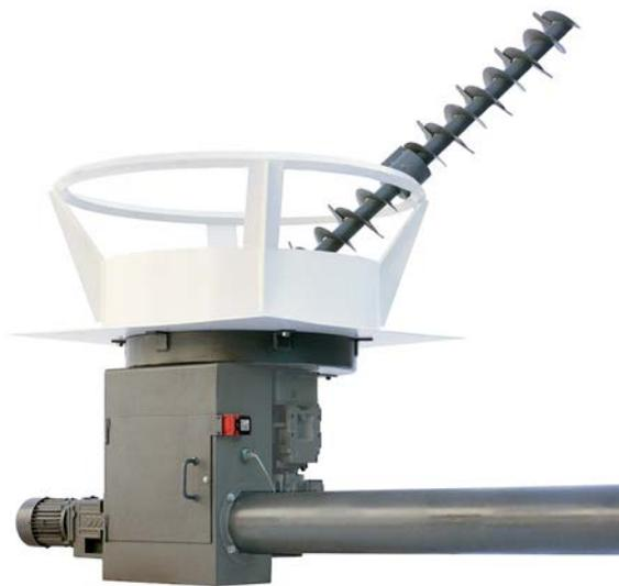
Pendelschnecken Siloaustragung von 3 bis 8 m Silodurchmesser für alle Arten von Holzspänen und Hackschnitzel bis Größe G 30 nach ÖNORM M 7133. Speziell auch für Siloanlagen die längere Zeit im Jahr nicht betrieben werden (Heizsaison).
